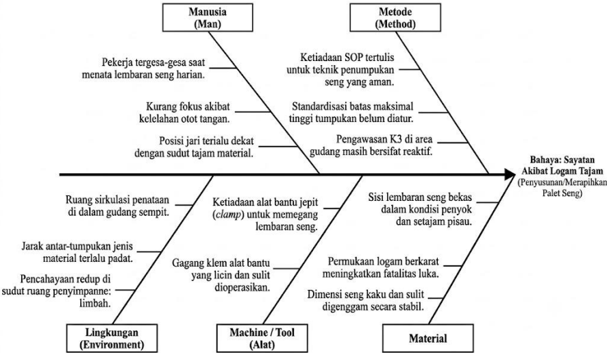
Gambar 1. Fishbone Diagram Penyusunan/Merapihkan Palet Seng Bahaya Sayatan
